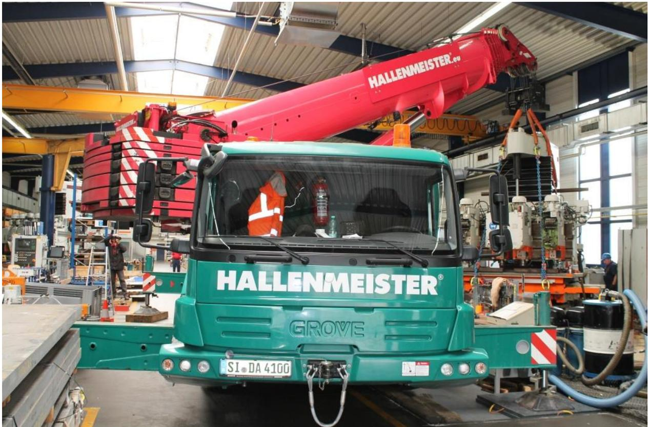
*Der HALLENMEISTER® hebt die Fräsmaschine aus dem bisherigen Fundament.*
